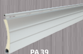
PA 39 pas de lame : 39 mm épaisseur : 9 mm
